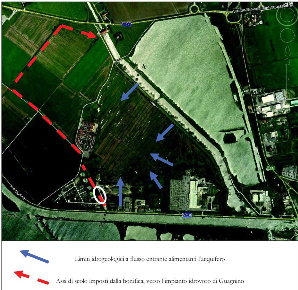
**FIGURA 2.7** - Modello concettuale in pianta su ortofoto e ubicazione della sezione idrogeologica A-A'.
